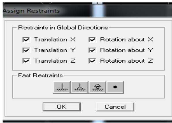
Fig. IV.19. Encastrement des appuis
