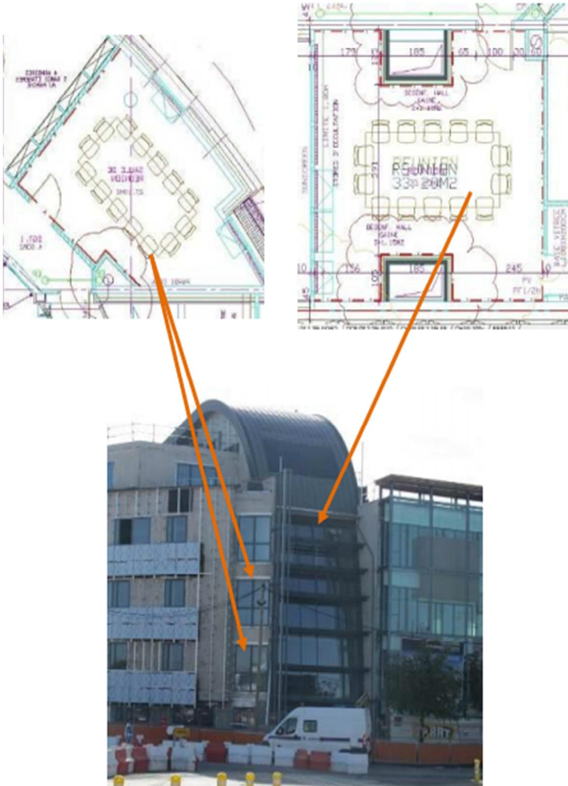
Figure 22 : plan de l'implantation des MCP dans les salles de réunions (2ème, 3ème étage)
