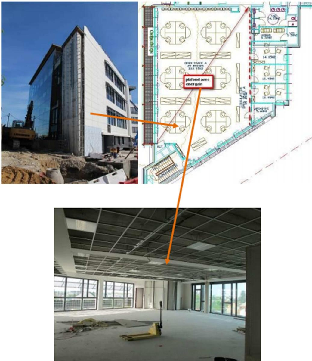
Figure 23: plan de l'implantation des MCP dans les open space (plafond)
