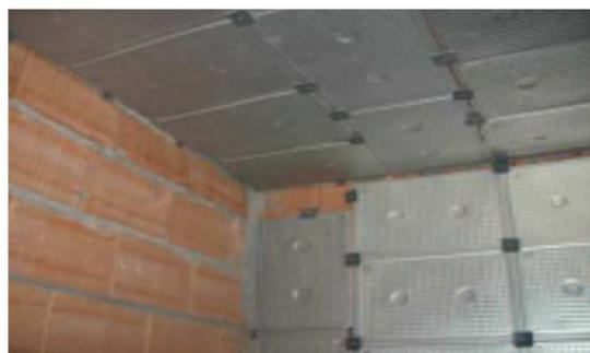
(e) Cabine en brique alvéolaire avec MCP (SP-25 A8)
