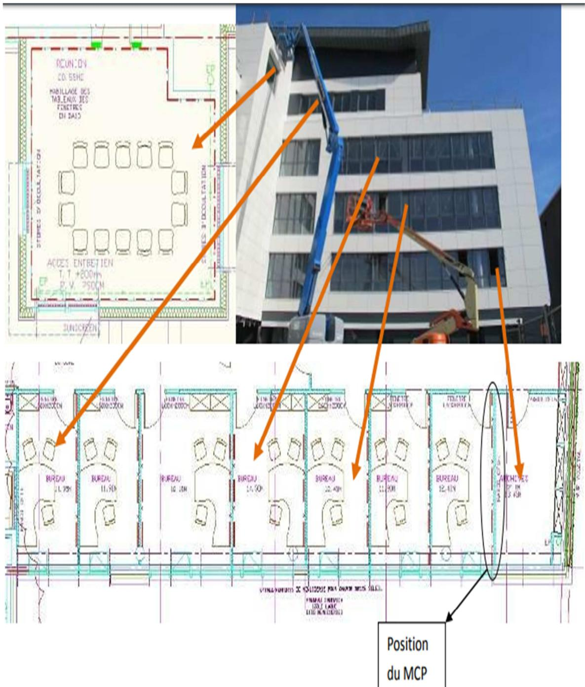
Figure 21 : plan de l'implantation des MCP dans les bureaux (1er, 2ème, 3ème et 4ème étage).
