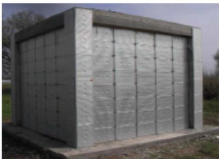
(b) Cabine avec isolation en polyuréthane et MCP (RT-27)
