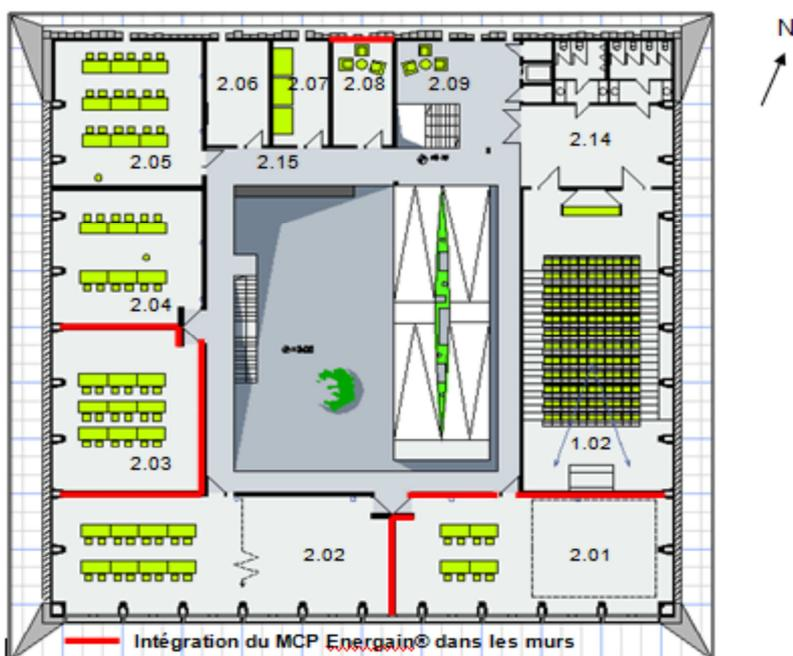
Figure 32 : Plan d'implantation des MCP dans le 2eme étage du bâtiment 3E.
