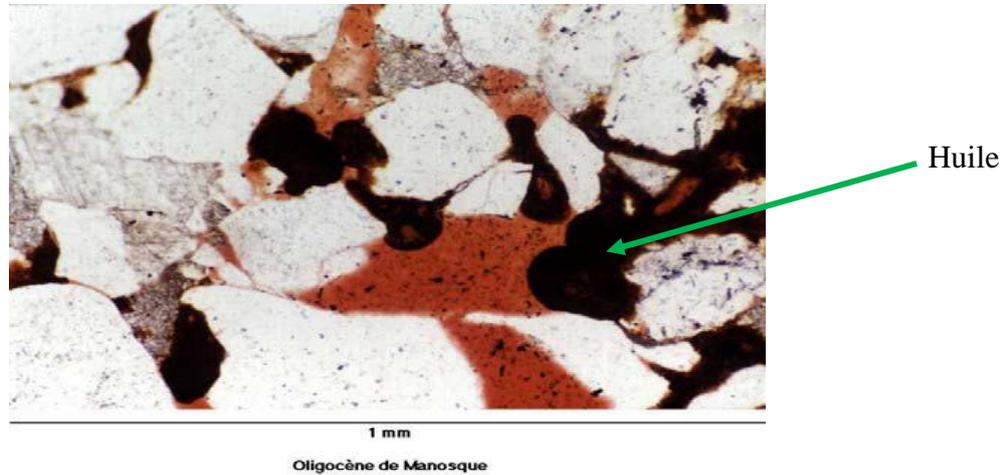
**Figure II.26 :** Lame mince montrant la saturation en huile.
