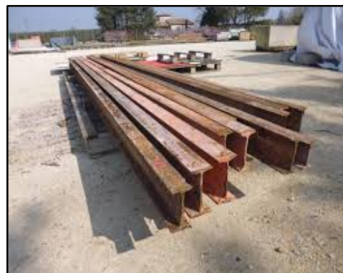
Figure 145 : poteaux métallique type IPN
