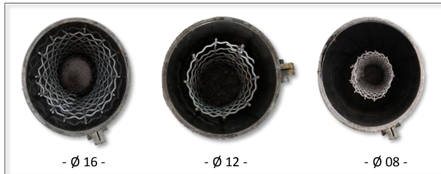
Figure II - 4 : Forme, diamètre et position des grilles à l'intérieur des éprouvettes
