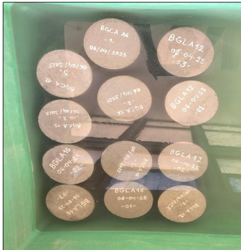
Figure II - 7: Conservation des éprouvettes dans un Bac d'eau
