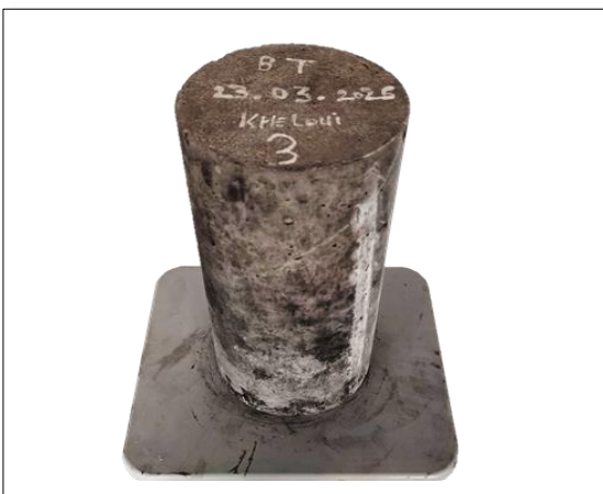
Figure III - 1 : Eprouvette Béton Témoin avant essai
