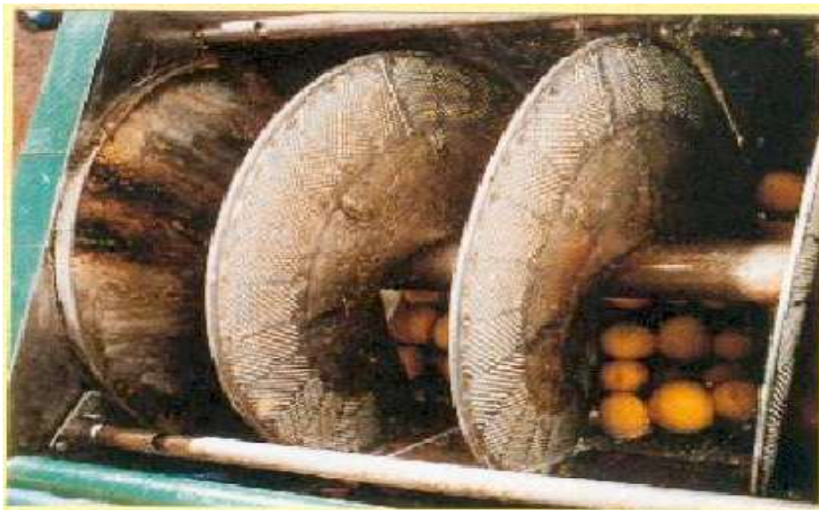
Figure 32 : presse hydraulique utilisée dans l'expression à froid
