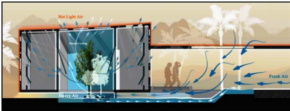
**Fig138:** Le Concept de refroidissement passif dans la Maison d'Alkhozama.
