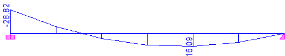
Figure VI-4. Schéma statique du mur plaque dans le sens Y-Y à l'ELU.
