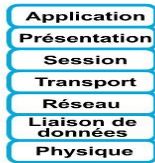
Figure III.8 : Les 7 couches du modèle OSI [3]
