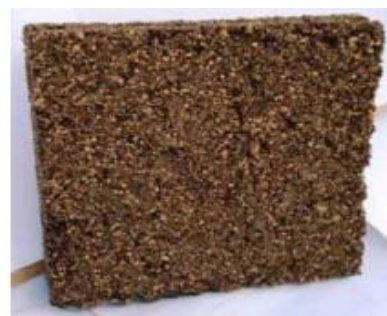
Figure.30: Echantillon d'isolant. Source : M. Dahli et R. Toubal (2010)
