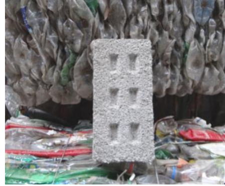
Figure.35: Vingt bouteilles de plastique recyclé pour produire une brique. Source : Build Green (2018).
