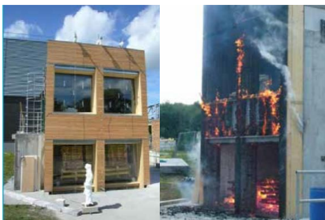
Figure.16: Maquette avant et après 30 mn du déclenchement du feu.
