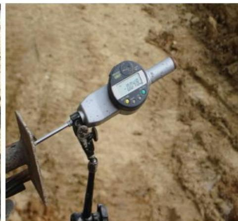
Fig.III.15. Comparateur pour la mesure de l'enfoncement de la chaise
