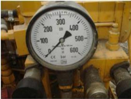
Fig.III. 12. Manomètre de contrôle
