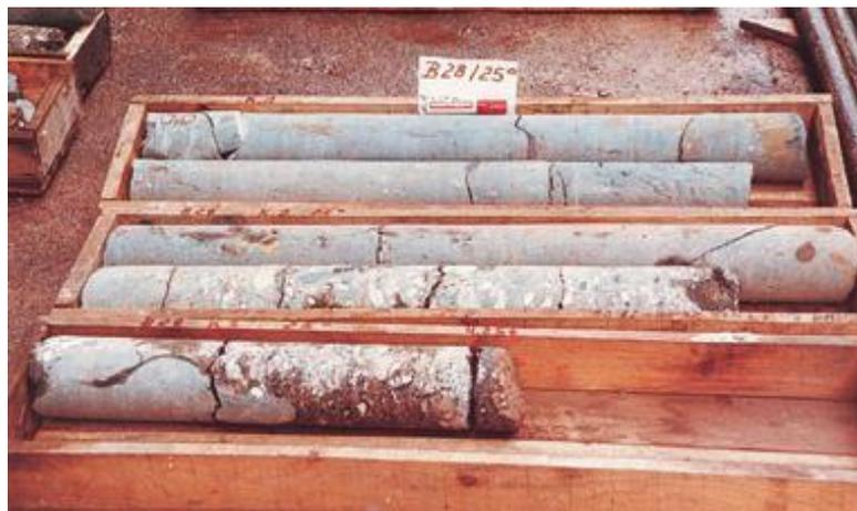
Fig. II. 77. Echenillant prélevé dans des éléments de jet grouting.
