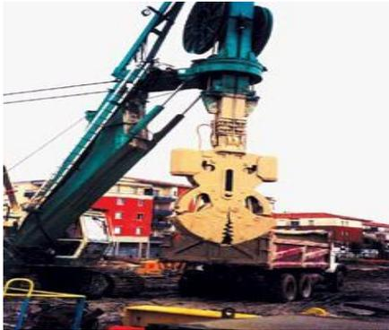
Fig. II.25. Benne preneuse.
