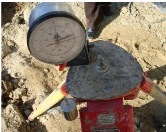
Fig. III. 14. Comparateur pour la mesure de l'allongement des tirants.
