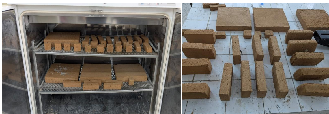
Figure II-22 : Procédés de séchage des briques crues – à l'air libre (droite) et en étuve ventilée (gauche) pour l'élimination de l'humidité résiduelle :
