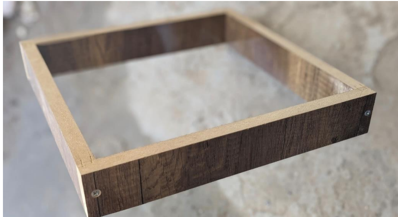
Figure II-16 : Moule en bois pour la réalisation d'une éprouvette cubique de 30 \times 30 \times 5 Cm
