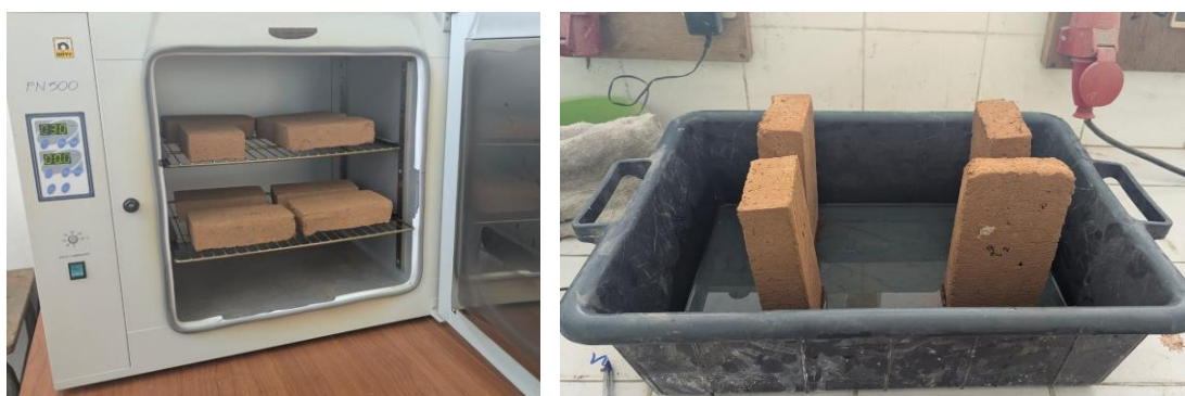
A B Figure II-27 : Matériel utilisé pour l'essai de capillarité
