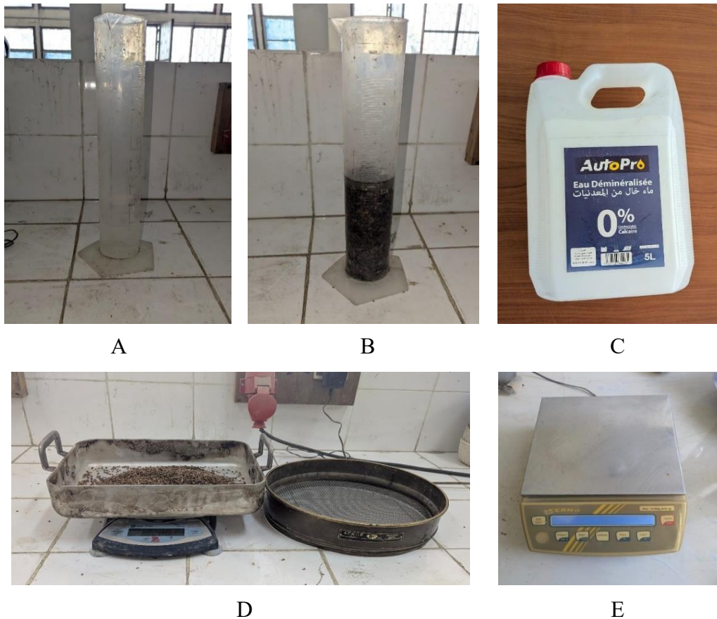
Figure II-10 : Matériel utilisé pour la détermination de la masse volumique absolue du grignon d'olive par déplacement d'eau Protocole expérimental
