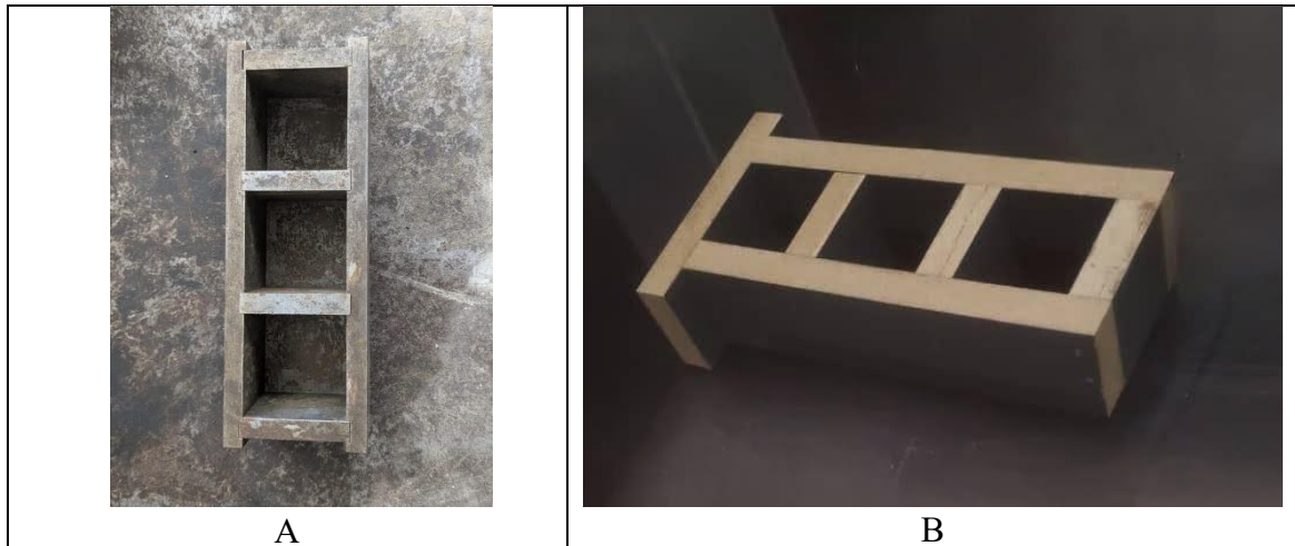
Figure II-14 Moule pour la confection des éprouvettes de dimension 5 \times 5 \times 5 cm pour la compression mécanique
