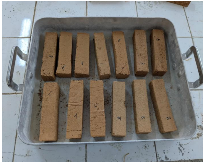
Figure II-19 : Échantillons prismatiques ( 16 \times 4 \times 4 cm) destinés aux essais de traction par flexion en trois points selon la norme XP P13-901
