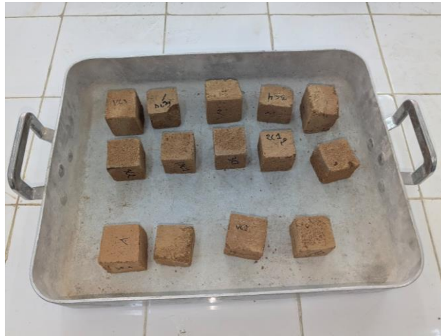
Figure II-18 : Échantillons cubiques ( 5 \times 5 \times 5 cm) réalisés pour les essais de compression uni axiale selon la norme NF EN 1015-11 (XP P13-901)
