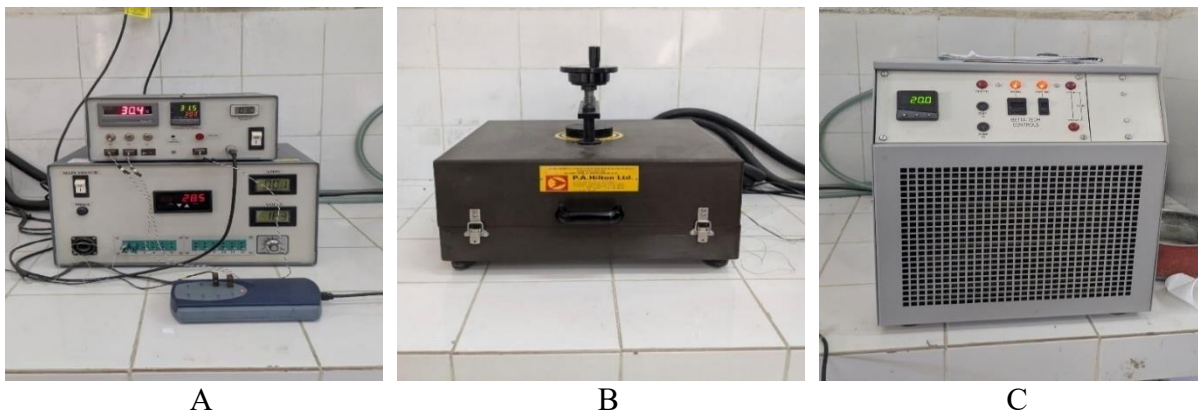
Figure II-25 : Matériel et manipulation de l'essai de conductivité thermique selon la méthode FLUXMETRE :
