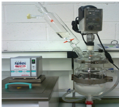
Figure VII.2 : Dispositif expérimental utilisé : Cuve cylindrique à double paroi, munie de quatre chicanes, agitée avec une turbine de Rushton.
