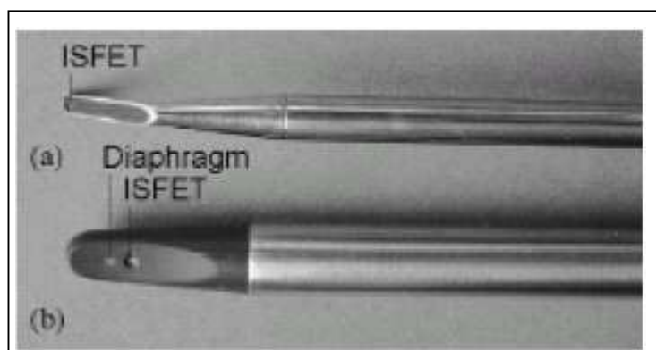
Figure-45- : ISFETs encapsulés en utilisant la technique de moulage. [19]
