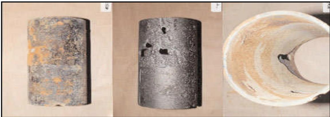
Figure V.1. Corrosion des conduites en fonte
