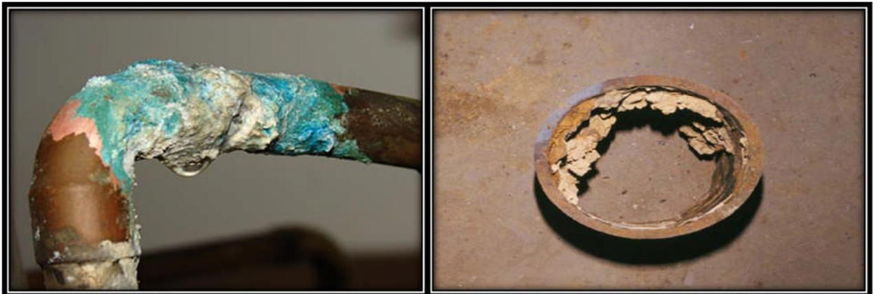
Figure VI.10 : la corrosion des conduites
