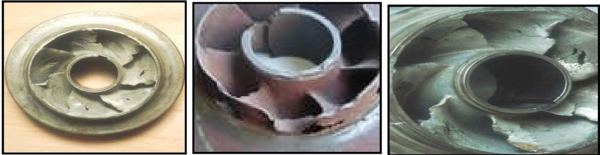
Figure VIII.8 : Photos illustrant le phénomène de cavitation sur des aubes de pompe
