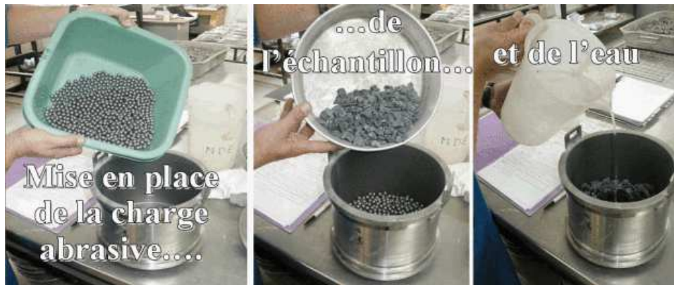
Figure VI. 2 : Mode opératoire d'essai micro Deval.
