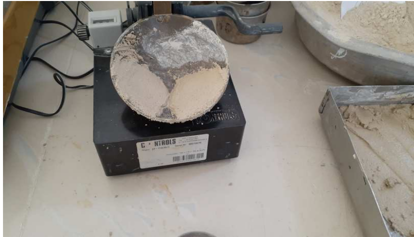
Figure III.14:essai limite de liquidité (WL).(NF P94-051)
