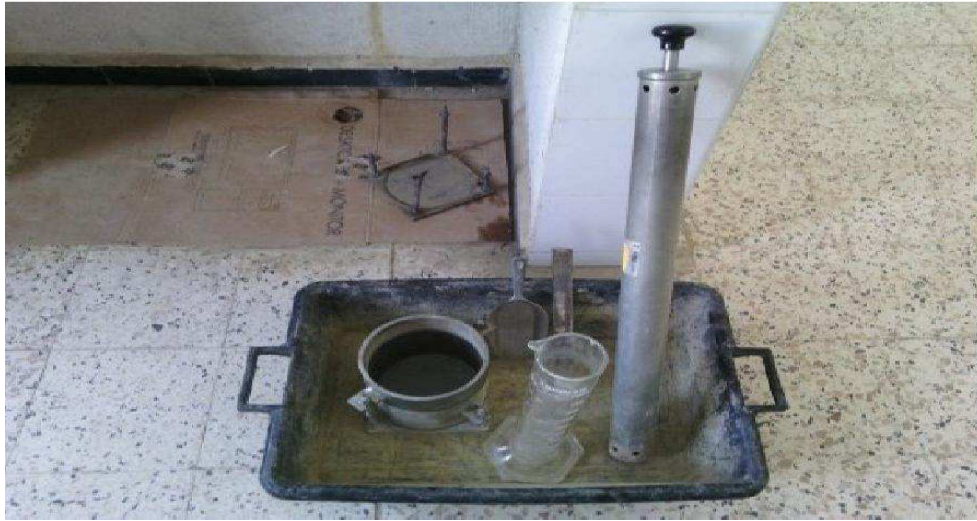
Figure. IV.6 : Matériel utilisé pour l'essai Proctor.
