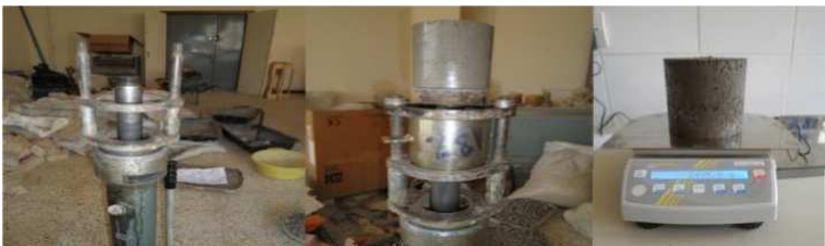
Figure IV.7 : Étape de démoulage du moule Proctor.
