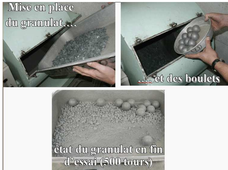
Figure VI.5 : Mise en place des granulats pour l'essai Los Angeles.
