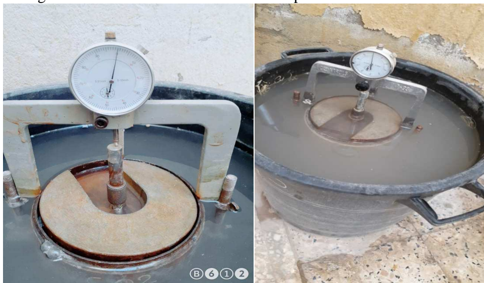
Figure VI.19. Phase d'imbibition et mesure du gonflement à l'immersion.
