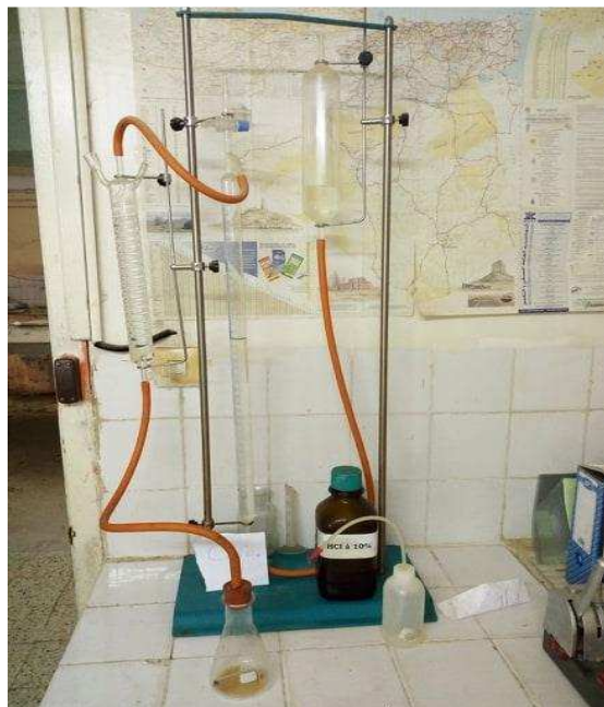
Figure III.18:Essai d'évaluation des carbonates \text{CaCO}_3 Déterminer à partir de la courbe d'étalonnage la masse m_2
