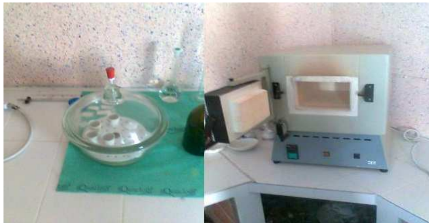
Figure III.15: Détermination des sulfates solubles dans l'acide.
