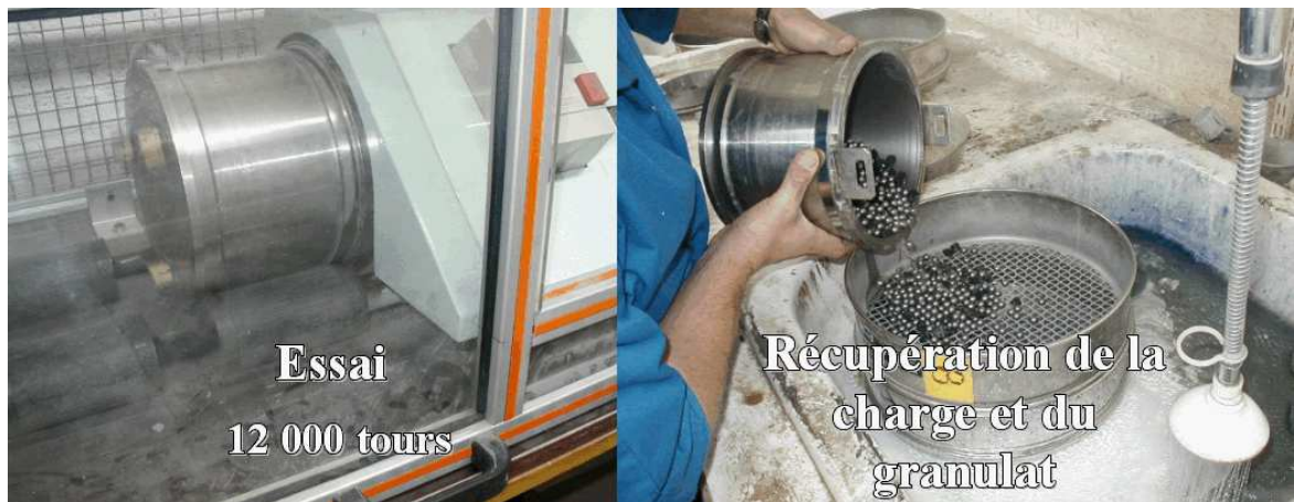
Figure VI.3 : Mise en place de l'échantillon et lavage du matériau (source : CETE).
