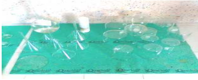
Figure III.20: Détermination des chlorures solubles dans l'eau.
