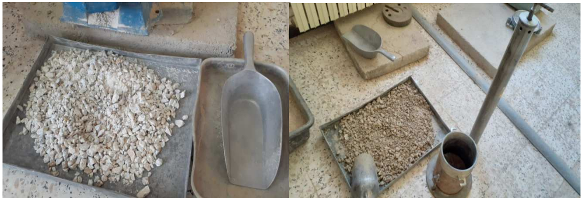
Figure IV.8 : Préparation du matériau pour l'essai Proctor.
