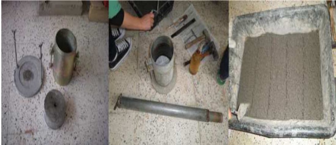
Figure IV.18: Matériel de confection des éprouvettes de l'essai CBR.
