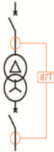
Figure .II.14 : Protection différentielle de transformateur
