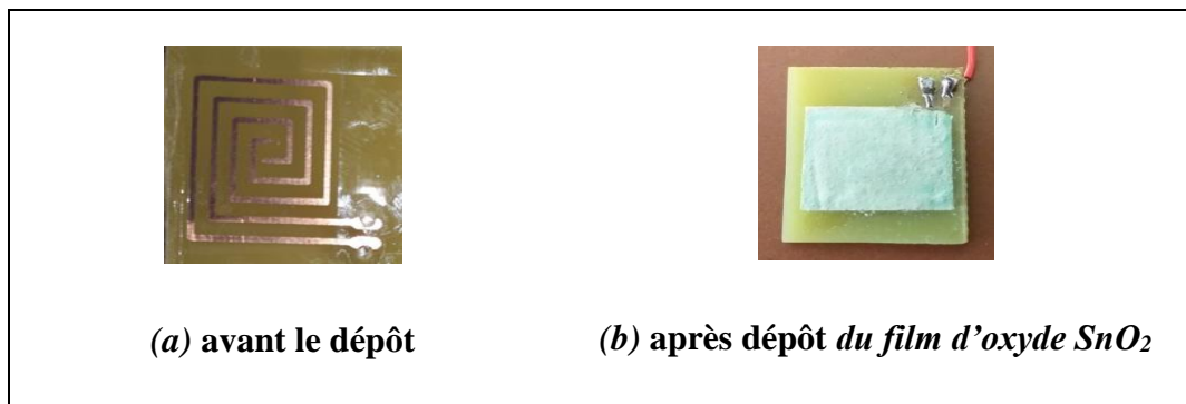
Figure II.8: Structures électroniques sous forme spirale
