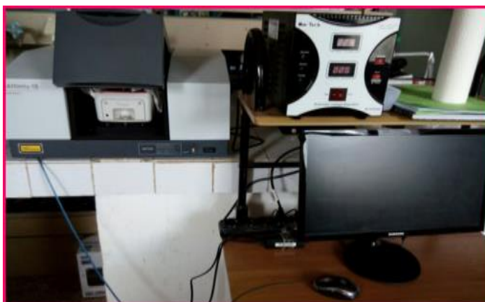
Figure II.2 : Photographie du spectromètre infrarouge à transformée de Fourier IRAffinity-1S.
