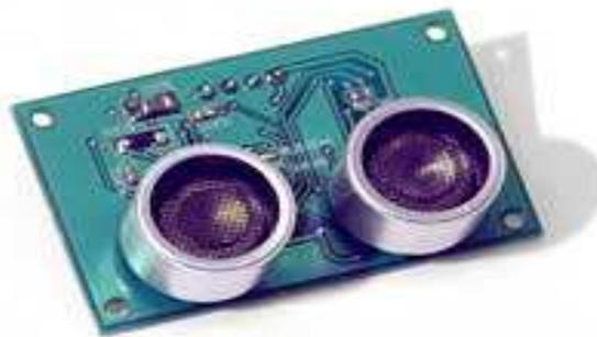
Figure III.5 : Module à ultrason DUR5200.
