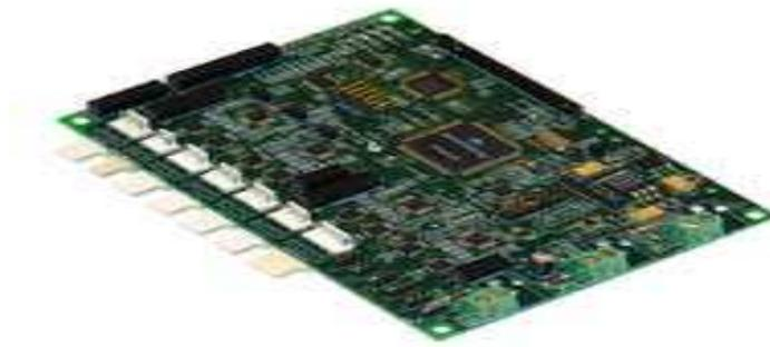
Figure III.12 : Contrôleur du mouvement et des sensations du robot-PMS5005- .
