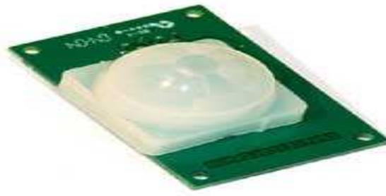
Figure III.9 : Module détecteur de mouvement humain-DHM5150.
