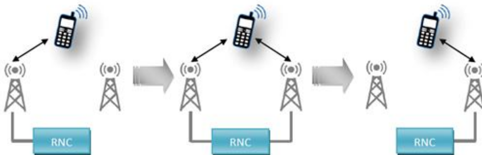
Figure. I.19. Exemple de soft handover
