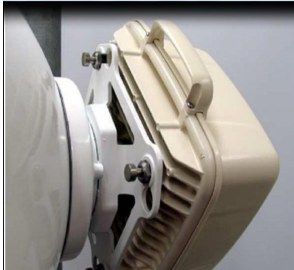
Figure.IV.3. exemple d'un ODU.
