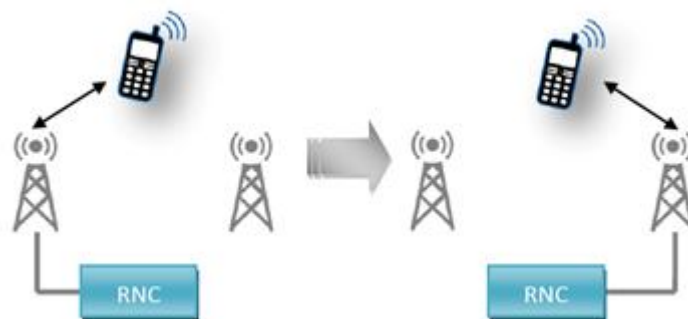
Figure. I.20. Exemple de hard handover
