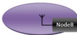
Figure .I.10. NodeB avec antenne omnidirectionnelle
