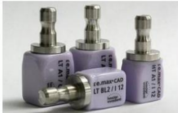
Figure 26 : Plots de vitrocéramique pour l'usinage
