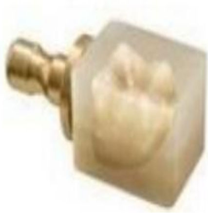
Figure 28 : lot de céramique feldspathique pour l'usinage avec vue en transparence de la future prothèse.
