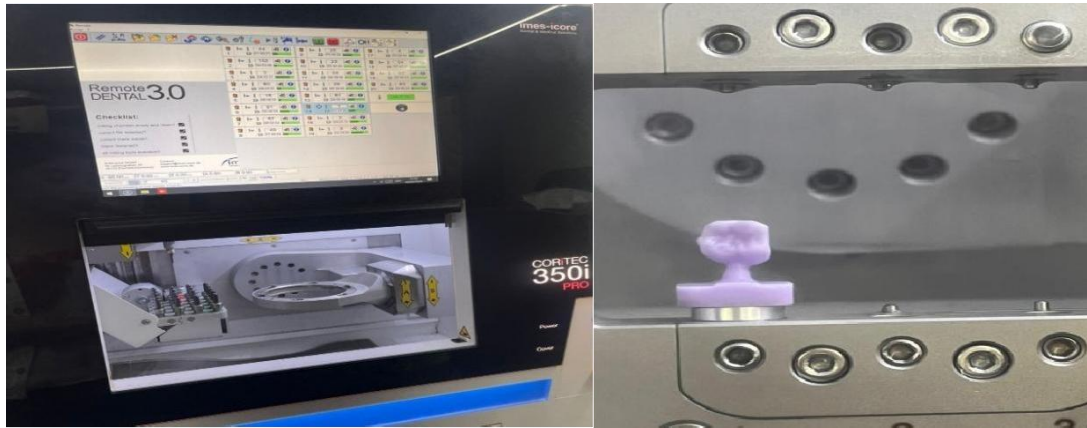
Figure 60 : envoi des informations numériques a notre machine de fraisage et lui insérer des fraises diamantes nécessaire pour un overlay pour fraisage de notre bloc de distillat de lithium
