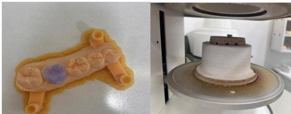
Figure 61 couper la tige et corriger les défauts si existe après en mets notre overlay pour glaçage pendant 20 minutes
