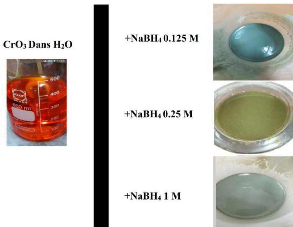
Figure IV.1-Processus de réduction et de changement de couleur des poudres en fonction de la concentration de \text{NaBH}_4 .
