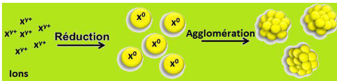
Figure I.3- Processus de formation des nanoparticules par réduction chimique.
