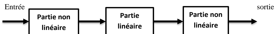
FIGURE 1.4: Modèle de Hammerstein-Wiener.
