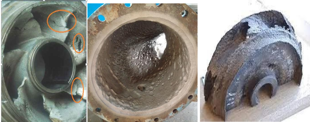
Figure V. 8. L'effet de cavitation sur la pompe.
