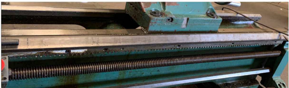
Figure III-23 : vis mère de glissière
