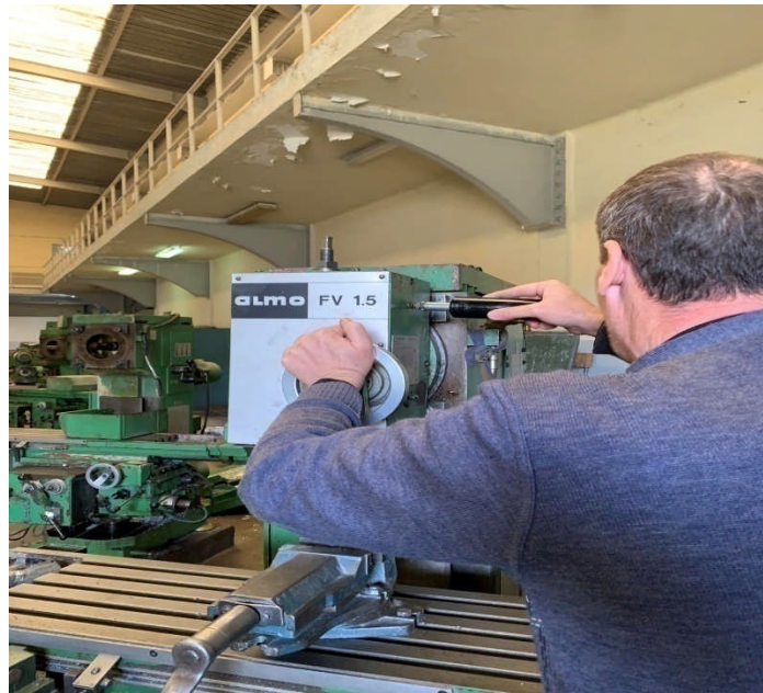
Figure III-24 : graissage de machine-outil manuellement
