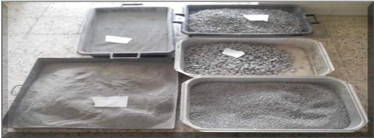
Figure III.6 : Granulats de schiste après concassage et tamisage.
