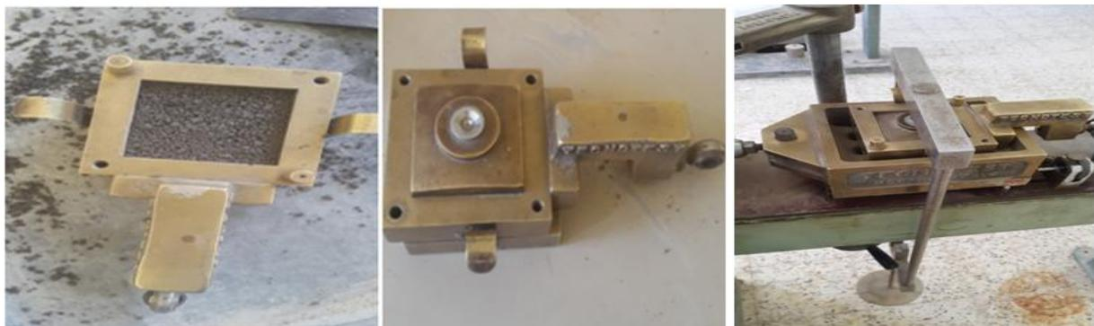
Figure VI.7 : Appareillage de l'essai de cisaillement à la boîte.
