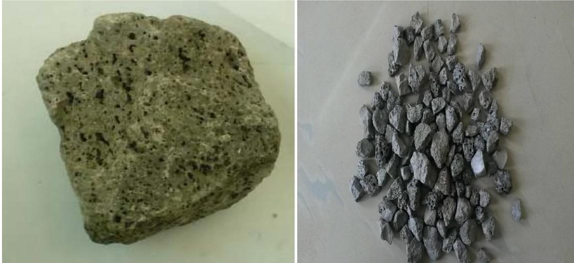
Figure II.12 : Laitier cristallisé.
