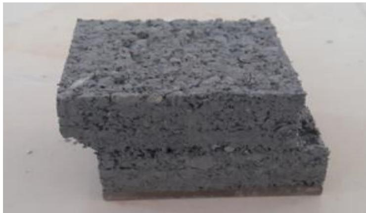
Figure VI.8 : Échantillon après cisaillement.
