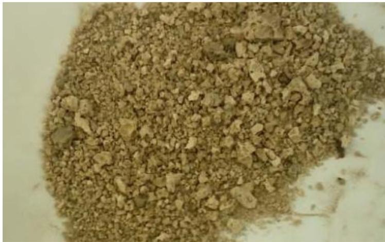
Figure II.11 : Laitier granulé
