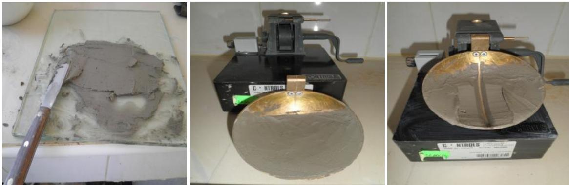
Figure III.12 : Détermination de la limite de liquidité.
