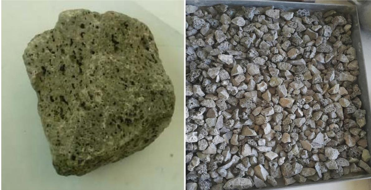
Figure III.3 : le laitier cristallisé.
