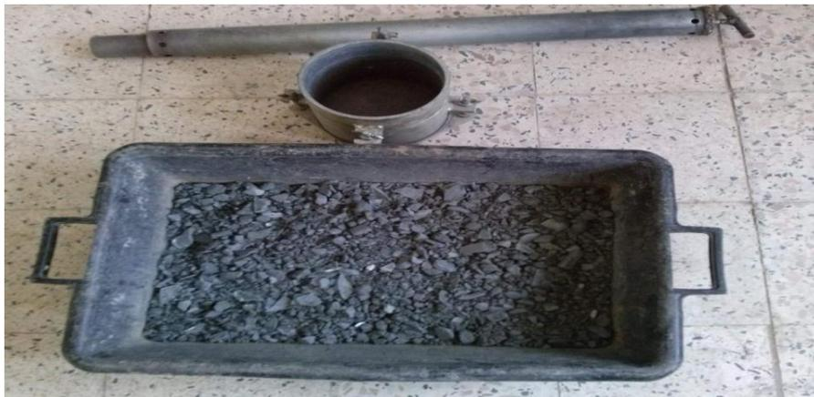
Figure IV.6 : Matériau schiste préparé pour essai Proctor.
