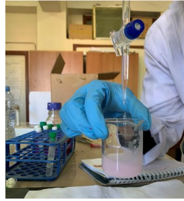
8 : début de disparition de couleur vers le transparent au point d'équivalence.
