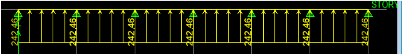
Figure -I-1-Le chargement à l'ELU pour les moments.
