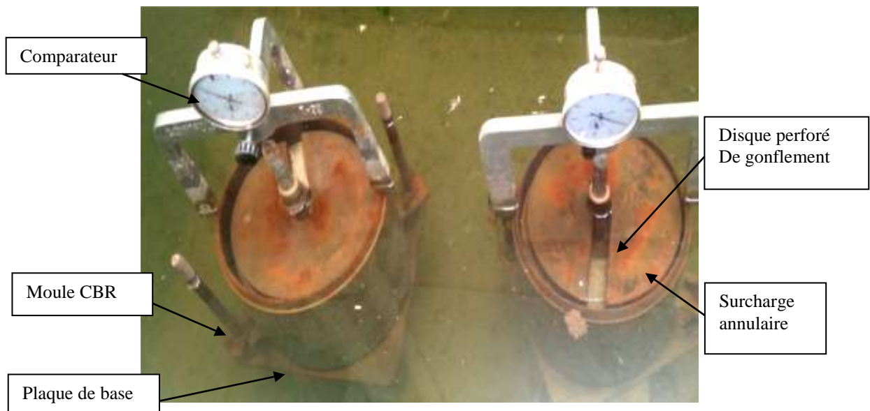
Figure IV.26 : Essai CBR après immersion, imbibition et gonflement.
