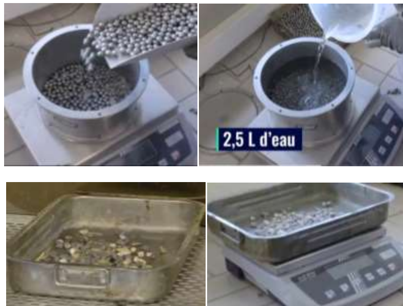
Figure V.2: Mode opératoire de l'essai micro Deval.
