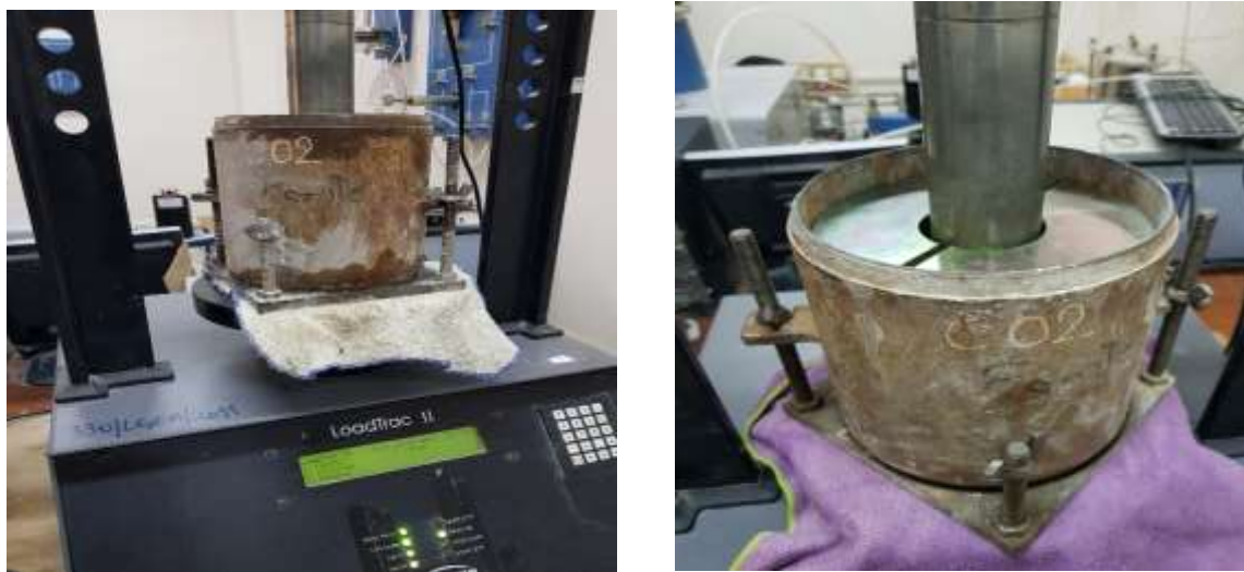
Figure IV.25 : poinçonnement des éprouvettes laboratoire LGEA
