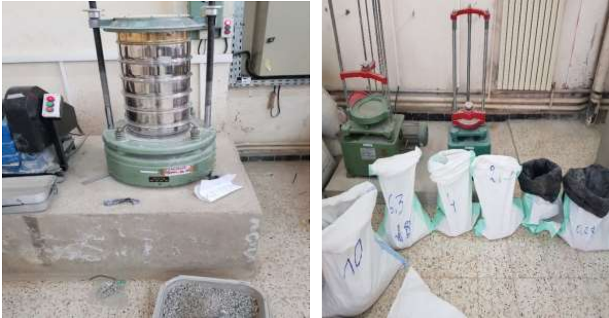
Figure III.4 : tamisage du béton NFEN13-285(2010).
