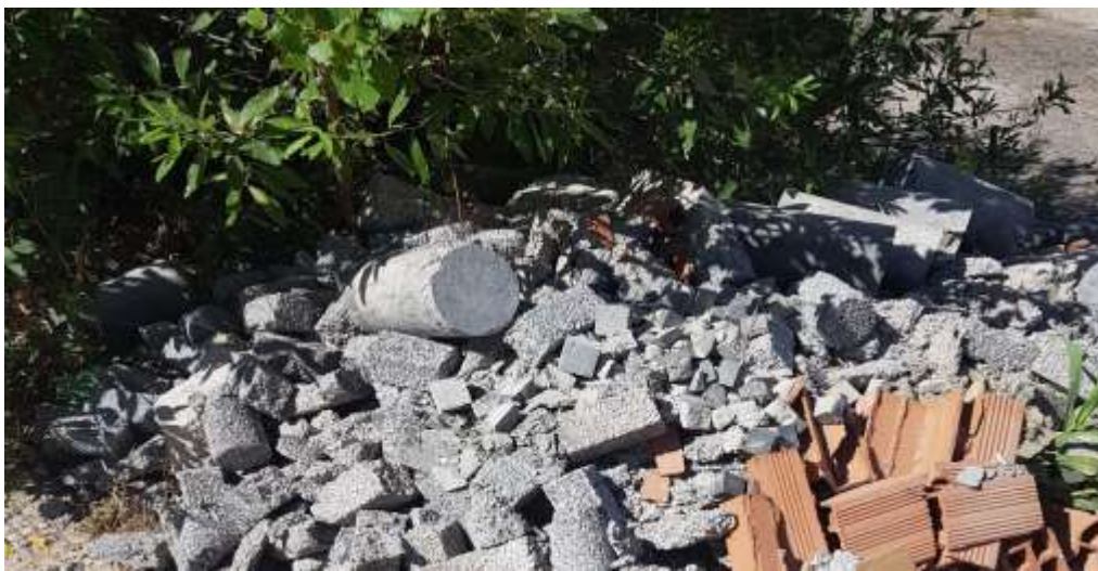
Figure III.2 : déchets du laboratoire de béton de la faculté.
