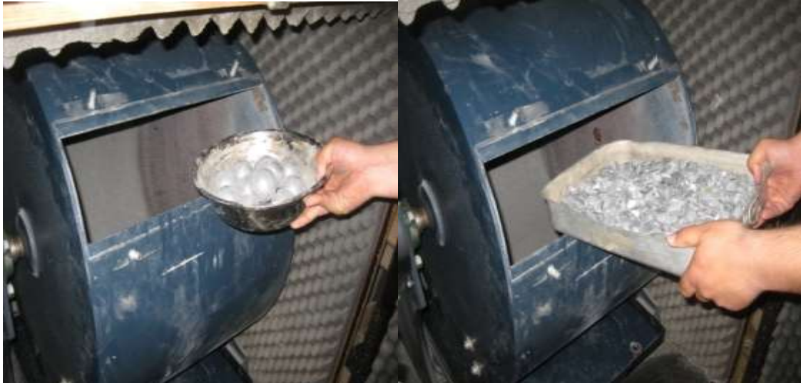
Figure V.4 : Mise en place des granulats pour l'essai Los Angeles.
