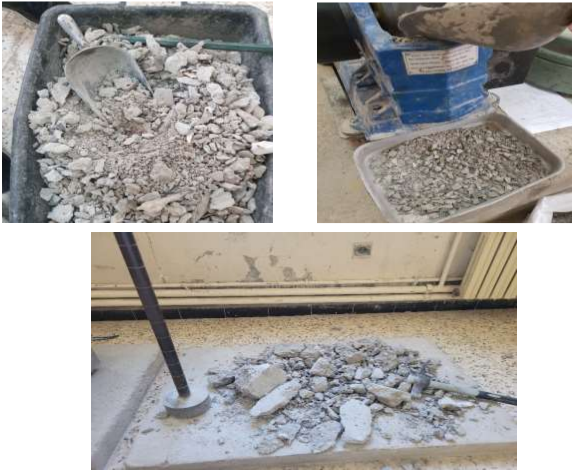
Figure III.3 : Concassage du béton
