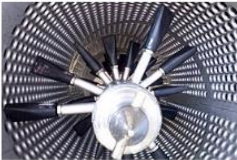
Figure 20 : Intérieur d'un égrappoir rotatif (cage et batteurs) (Colas, 2015).
