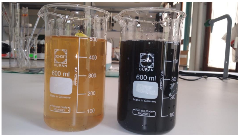
Figure IV-30 Lixiviat avant et après traitement par aération intensive
