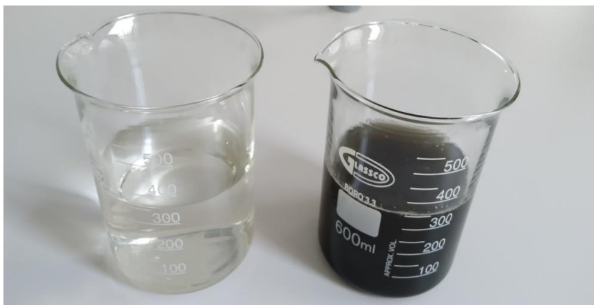
Figure IV-28 lixiviat avant et après traitement par SBR couplé à la coagulation-floculation.
