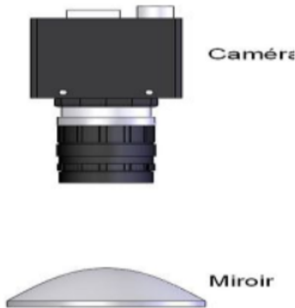
Figure III.33 : Exemple de capteur catadioptrique.
