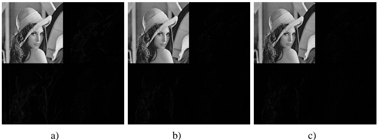
Fig.IV.2 : Décomposition de l'image Lenna par trois types d'ondelettes a) ondelette Haar b) ondelette Daubechies c) ondelette Coiflet
