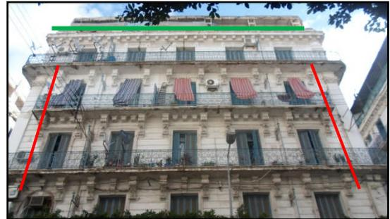
Figure III.27 : La clôture de la forme : la façade est limitée par une corniche et deux pilastres de part et d'autres qui jouent le rôle de blocage supérieur et latéral. Immeuble N°48, rue Ben M'hidi (Source : l'auteure, 2012).
