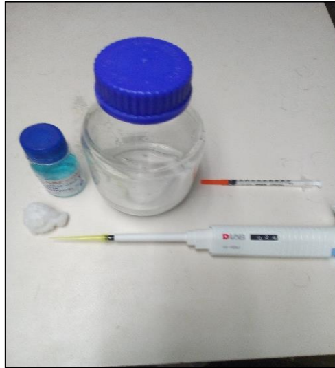
Figure 12 : Matériel et produits d'injection : micropipette, seringue, alcool, coton et acétate de plomb en solution.(Original,2023).
