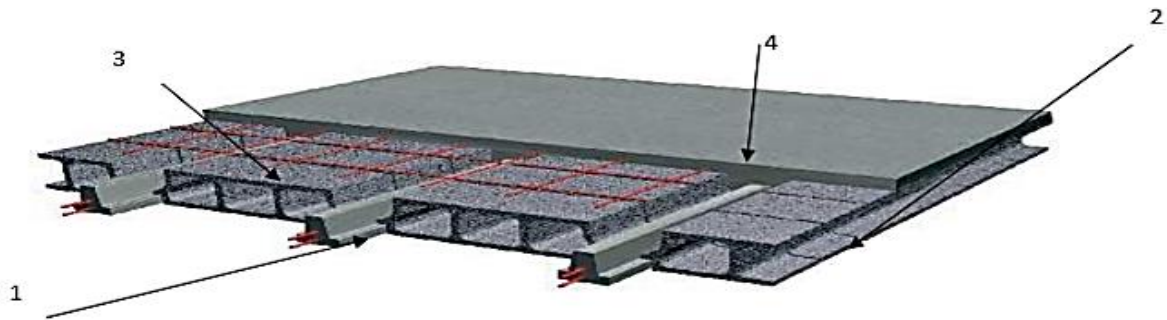
Figure II.1 : Coupe d'un plancher à corps creux
