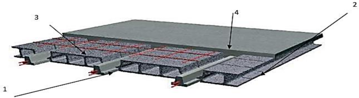
Figure II.1 : Coupe d'un plancher à corps creux
