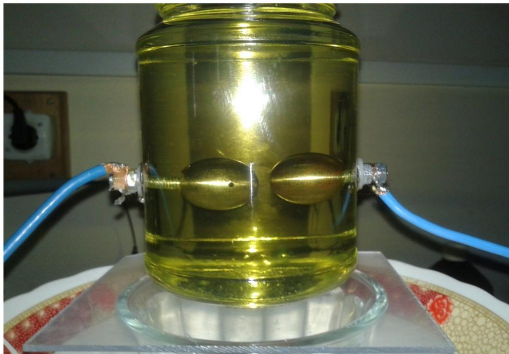
**Figure 16 :** Vue de la cellule expérimentale réalisée (avec l'échantillon d'huile BORAK 22)
