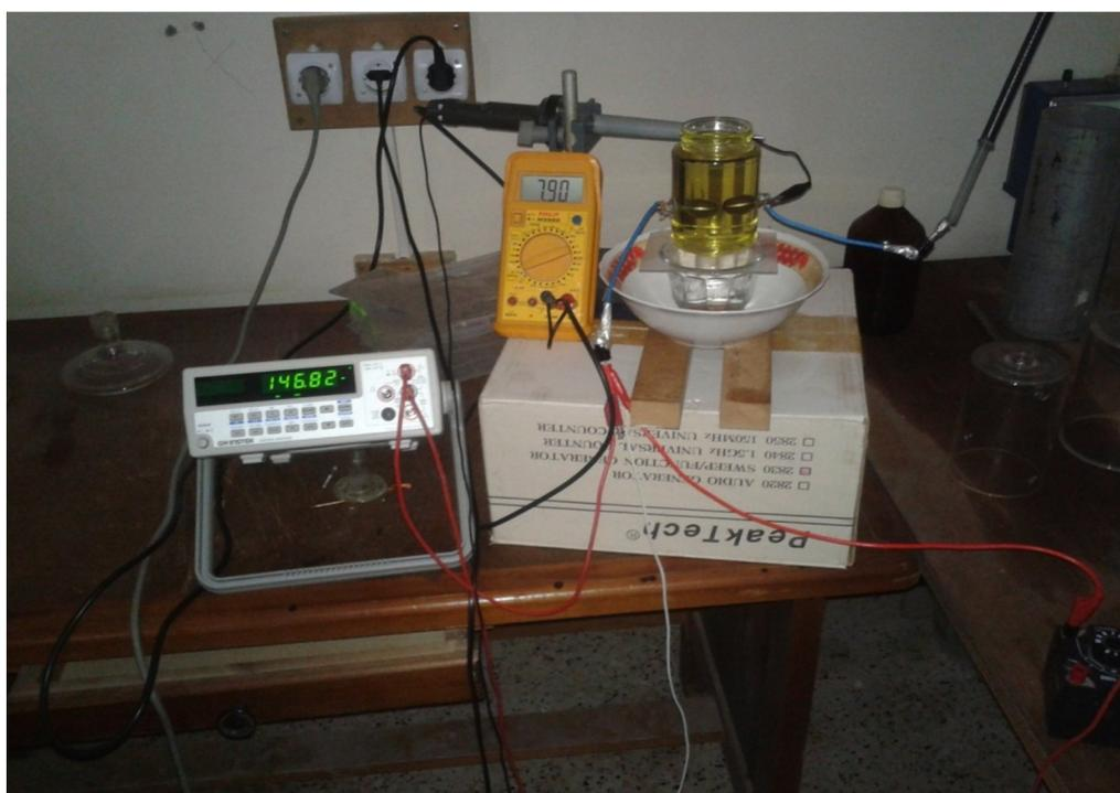
**Figure 17:** Vue de l'ensemble du système expérimental (la source de tension n'apparaît pas mais la sonde est visible)
