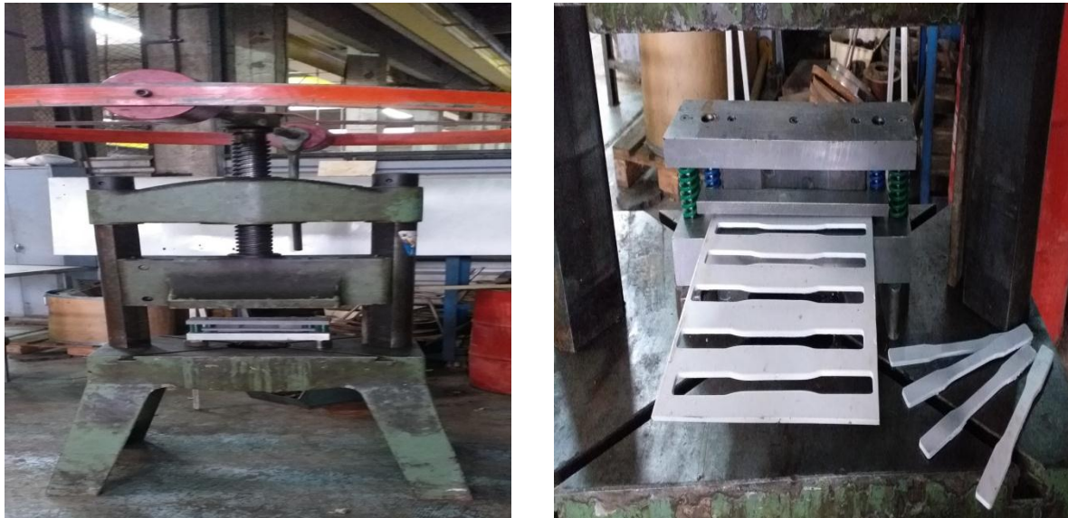
Figure III- 3: Montage poinçon-matrice sur presse (atelier centrale ENIEM).
