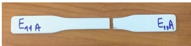
Figure III- 12: Eprouvette en HIPS après l'essai de traction
