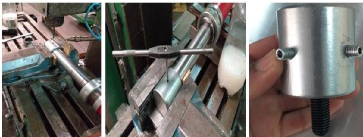
Figure II- 36: Opération de perçage et taraudage sur la tête du piston pour mettre en place les vis de pression et la vis de fixation.
