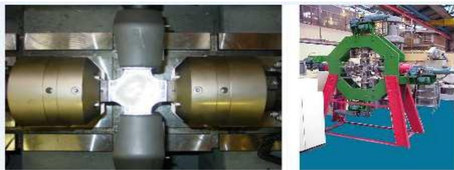
Figure I- 39 : Image de gauche : éprouvette de traction biaxiale montée. Image de droite : dispositif de traction biaxiale de laboratoire 3s à Grenoble.
