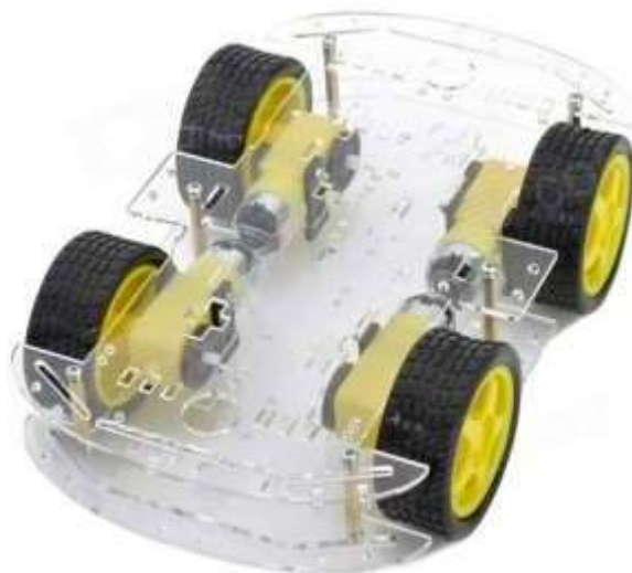
Figure III.3 : Image des moteurs fixés aux coins du châssis, montrant également les connexions aux roues.
