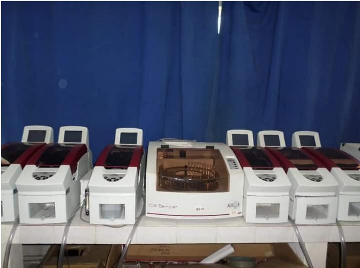
**Figure 10** : auto analyseur pour le dosage du phosphore total
