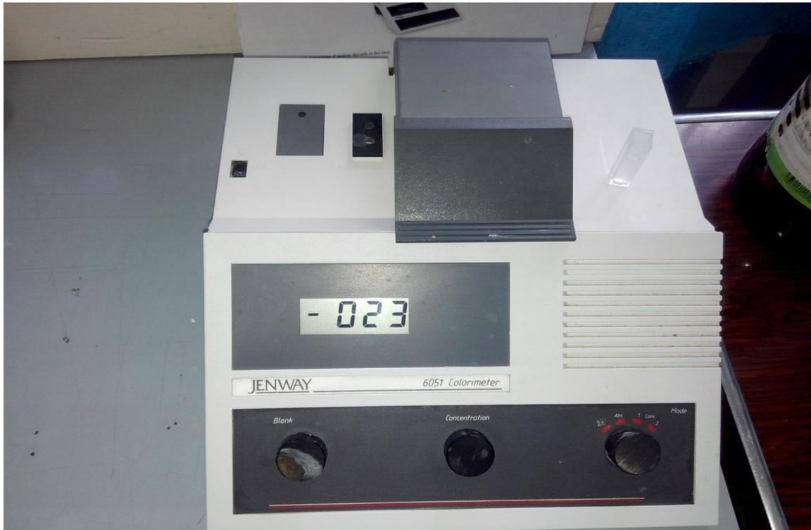
**Figure 6:** Colorimètre pour le dosage du phosphore assimilable
