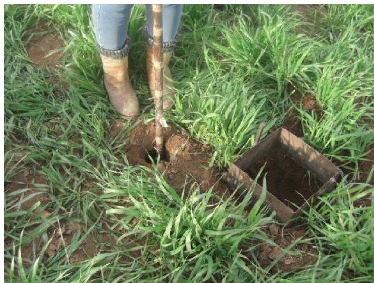
Figures 7. Méthodes de prélèvement du sol (a : l'aide d'un quadrat, b : avec une tarière)
