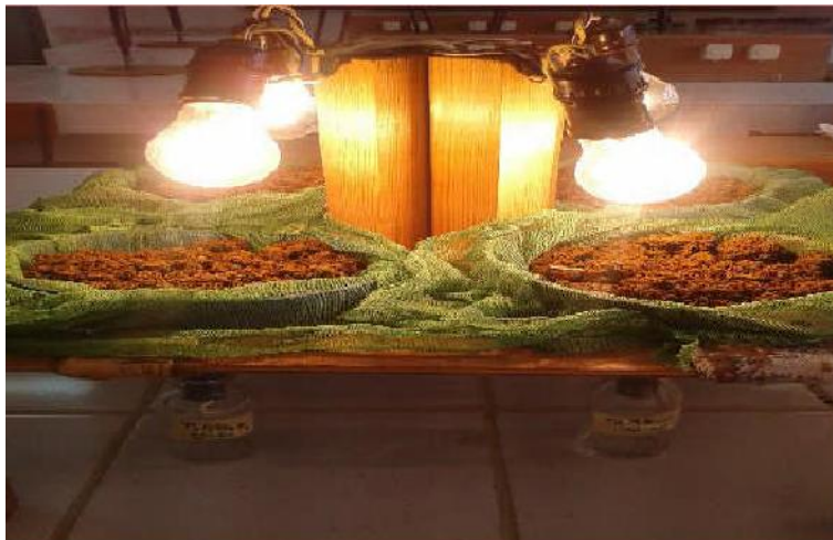
Figure 8. Extraction de la faune du sol selon le dispositif de Berlèse-Tullgren
