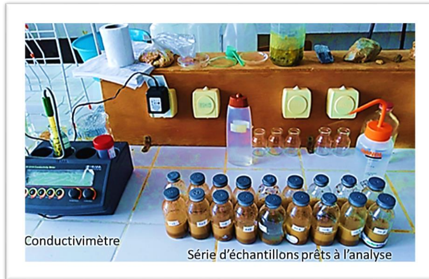
Figure 4: Illustration de la mesure de la conductivité électrique.
