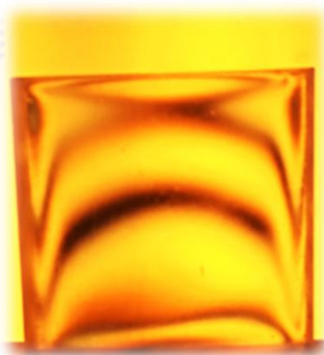
Figure III-20: Observation des contraintes résiduelles
