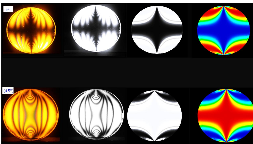
Figure III-17: Isoclines obtenus numériquement et expérimentalement ( 0^\circ ) et ( 45^\circ ).
