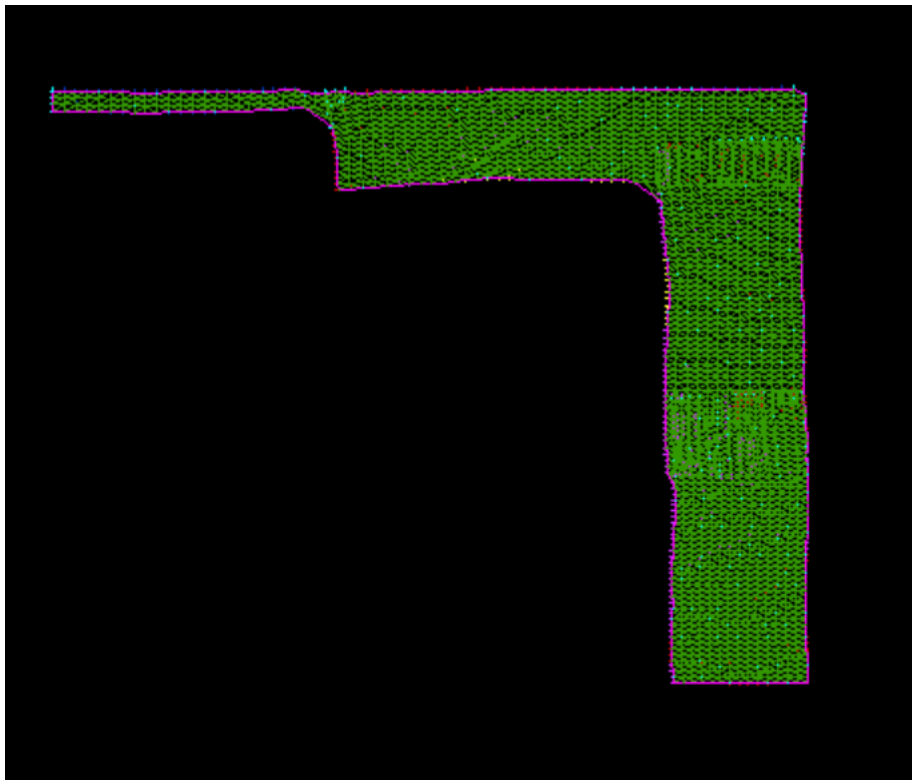
Figur-3: Triangulation du levé topographique.
