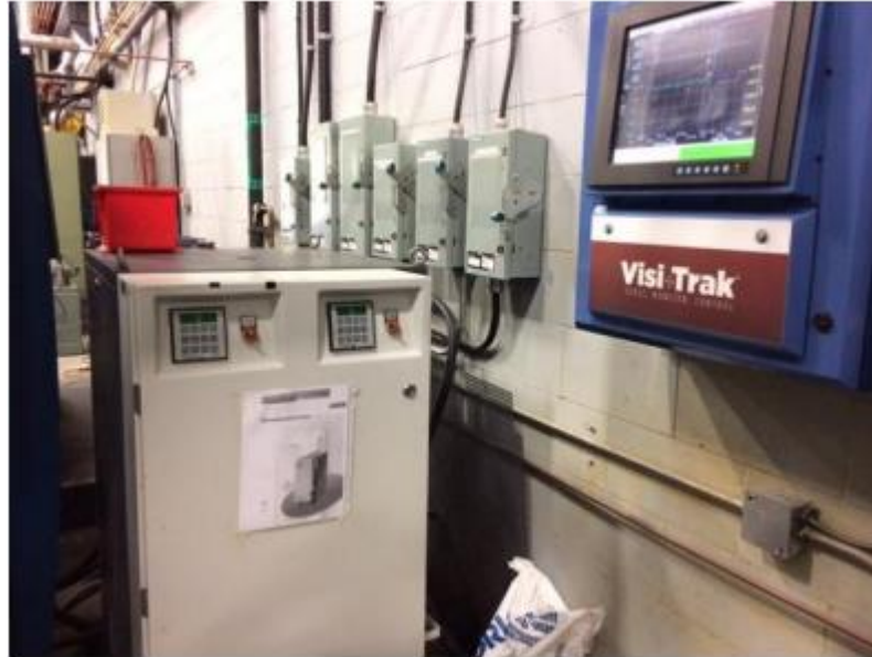
Figure 23: Chauffage moule et système de pilotage en temps réel (à droite)
