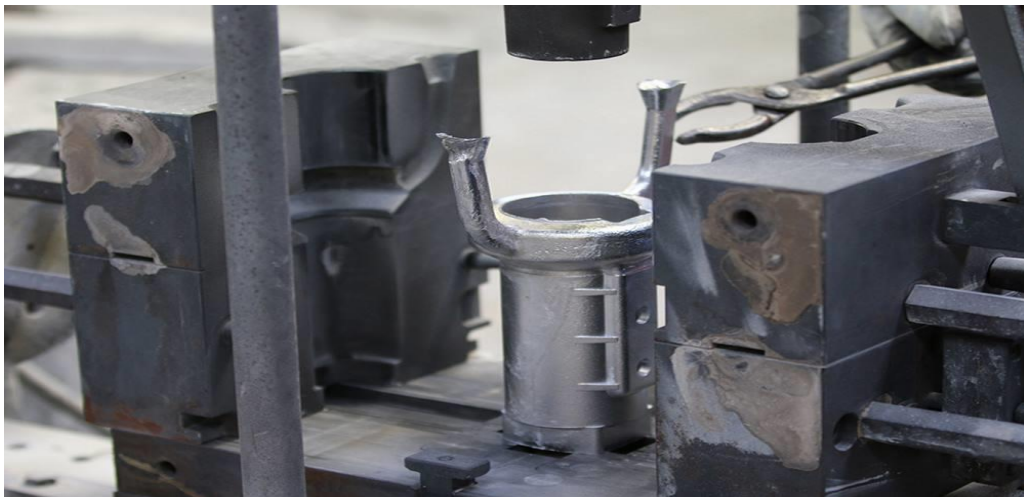
Figure 16: moulage en couquille d'une pièce en aluminium
