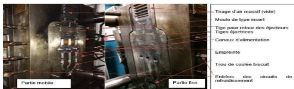
Figure 19 : Éléments d'un moule sous pression
