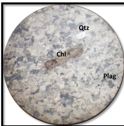
Fig. IV-17: Chlorite dans les calcaires
