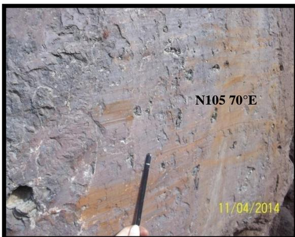
Fig. III-21: Miroir de faille dans les calcaires, montrant un décrochement
