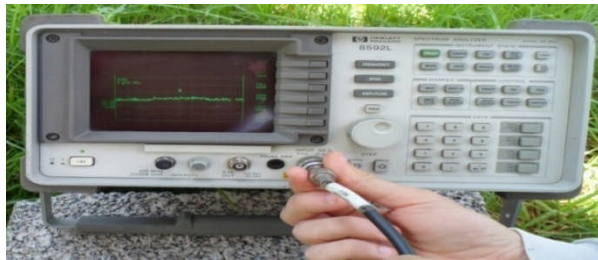
Figure IV.27: le signal bruit capté par l'antenne VSAT.
