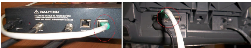
Figure IV.46 : câblage IP-Phone au modem.
