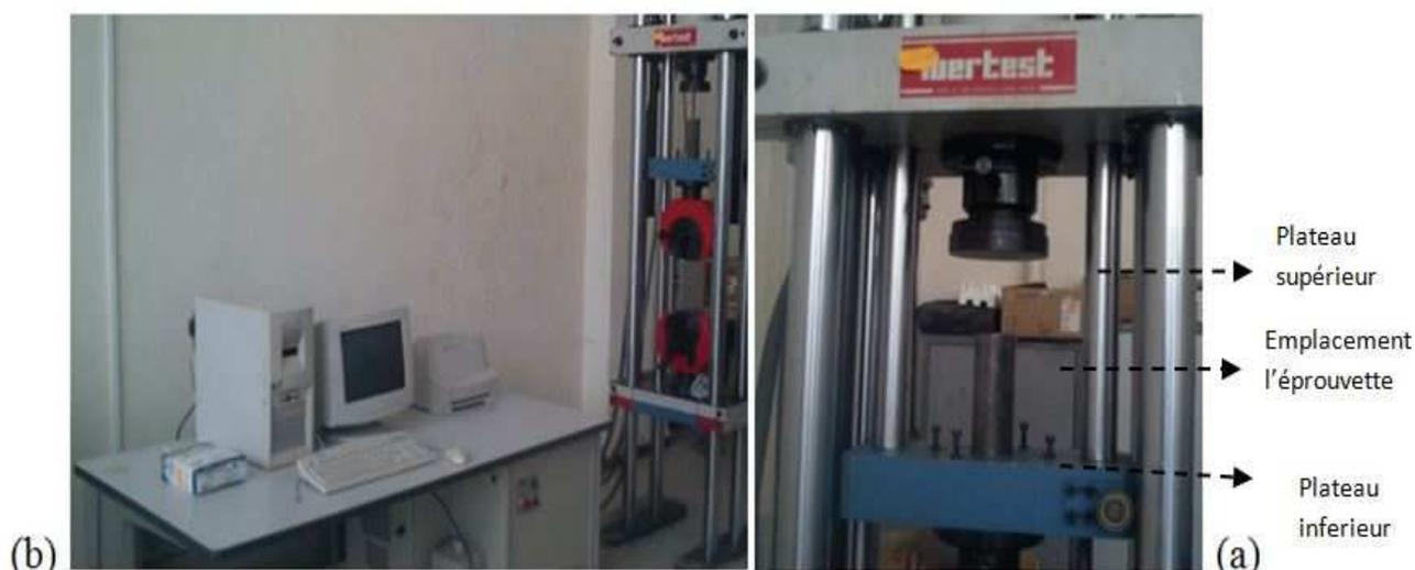
**Figure III.6** (a) Machine de compression IBERTEST, (b) micro-ordinateur lié à la machine
