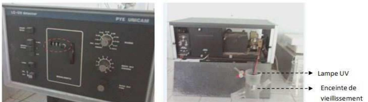
**Figure III .3 :** Dispositif de vieillissement par UV
