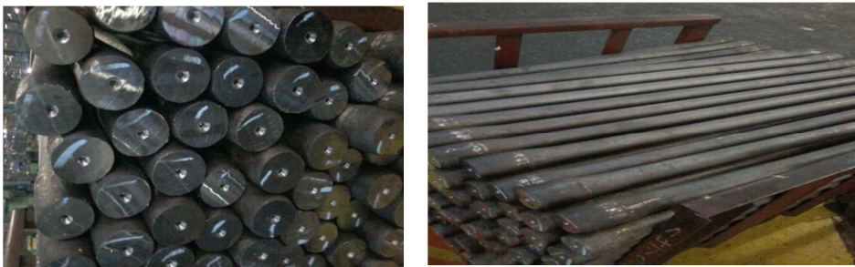
Figure 1.1 : Pièces après fraisage et centrage sur M3T.
