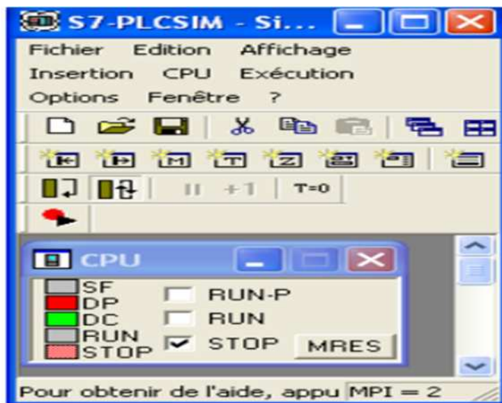
Figure.1 : Fenêtre du S7-PLCSIM.
